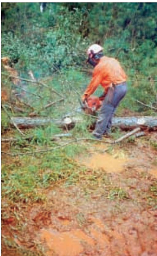
**El trabajo seguro con motosierra exige el uso de elementos completos de protección personal, que debe aportar el empleador. El ruido, las vibraciones, junto a condiciones de altos ritmos, insuficiencia de pausas y exposición al frío pueden generar diferentes enfermedades profesionales.**
