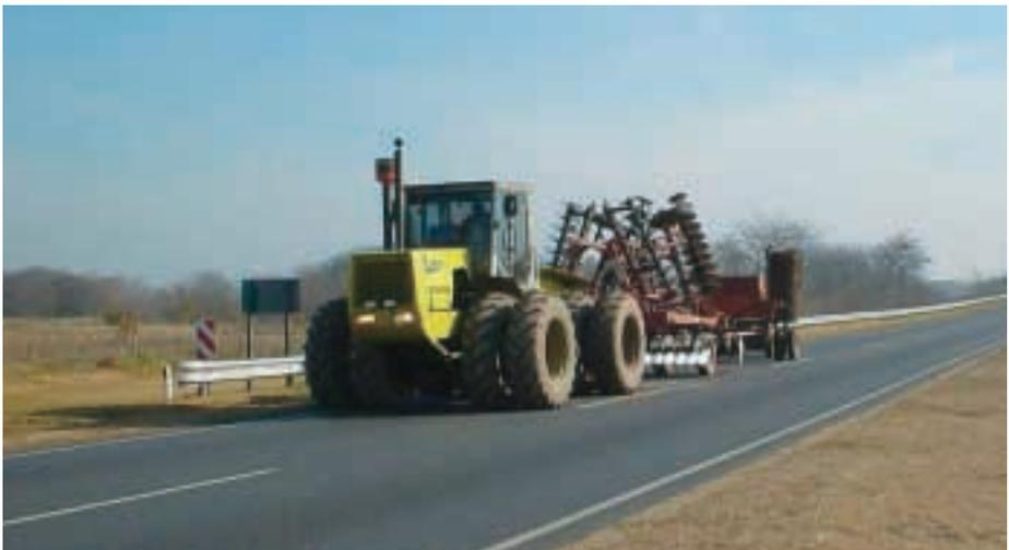
**El transporte de la maquinaria debe respetar las normas viales vigentes. No pueden sobresalir partes del equipo porque ponen en riesgo a los vehículos que circulan por el otro carril.**
