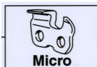
Debido a la forma más delgada, aplanada lateralmente de la placa de corte del diente, se produce menos resistencia de corte en el aserrado, por eso se consigue con este tipo de cadena un mayor rendimiento.
