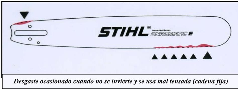
Debido al desgaste de los almas de la espada se reduce la profundidad de la ranura, esta debe medirse en el sitio de mayor desgaste antes de colocar la cadena. Hay que mantener una profundidad de la ranura, correspondiente al tipo de espada.
